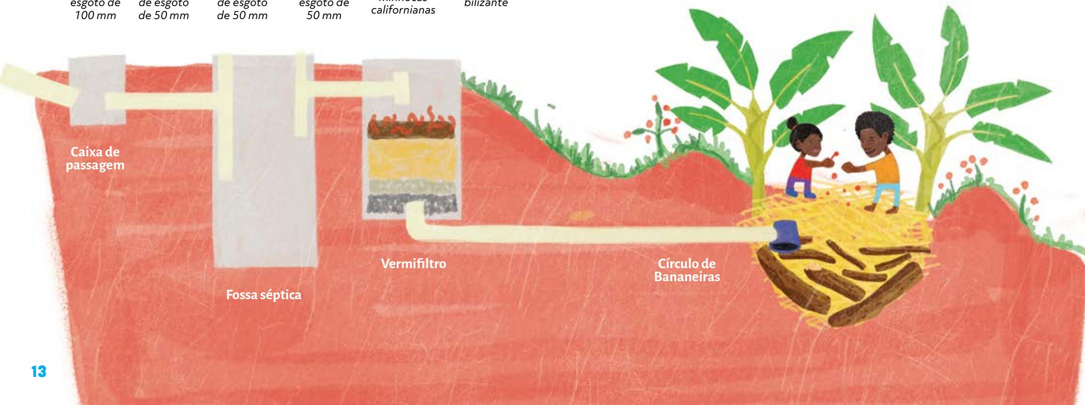
A tubulação segue até a entrada da fossa séptica, deixando um espaço livre entre o topo do tubo e o topo da borda do anel de concreto. A saída da fossa deve ser feita do lado oposto do ponto de entrada, com o nível inferior do tubo a 5 cm abaixo do tubo de entrada. Os espaços vazios entre os tubos e o anel de concreto devem ser preenchidos com nata de cimento, ou argamassa forte (3:1), e toda a superfície interna, impermeabilizada.
